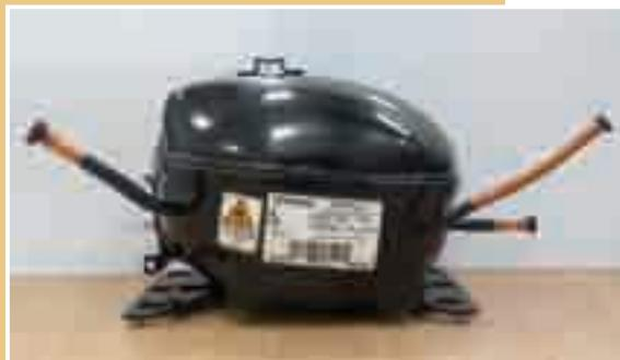
超高效变频压缩机 VESF11C 作为恩布拉科最新一代变频产品，适用于 100 ~ 240V 不同额定电压，系统工况能效可达 2.3W/W，由于采用了新型材料及结构，压缩机高度仅有 139mm，重量仅为 6kg，制冷量覆盖 27 ~ 266W，可以在 950 ~ 4500r/min 之间无缝切换。
