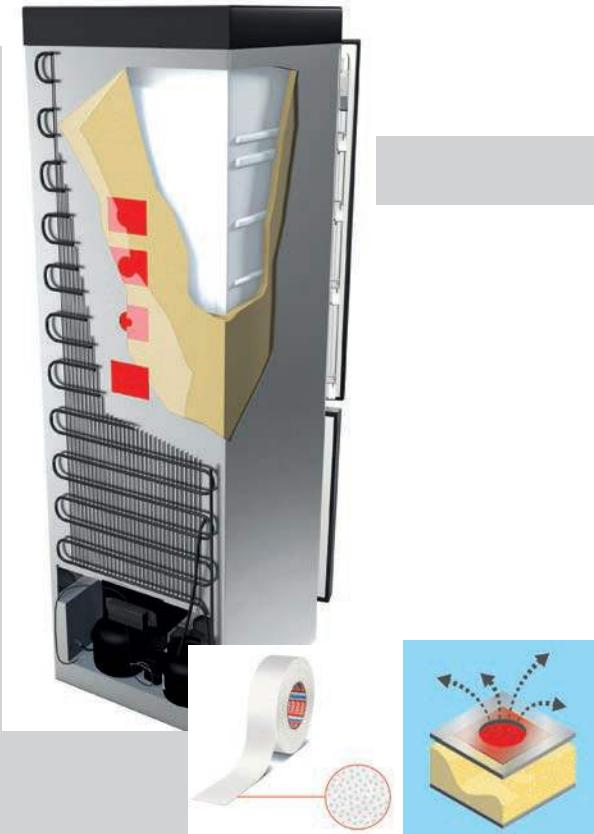
不少家电生产过程中会涉及聚氨酯（PU）发泡的工艺，PU经过发泡后具有保温、节能降耗的作用，例如冰箱箱体、冰箱门等都用到PU发泡材料。在发泡时，注射机将PU发泡材料高压注入腔体中，并将腔体中的空气通过小孔排出去，此时就需要透气胶带发挥作用，让腔体中的气体快速通过，同时阻止发泡材料溢出。如果不使用性能优异的透气胶带，则不能快速将空气排出，使得发泡材料固化后形成一个气腔，影响美观。
