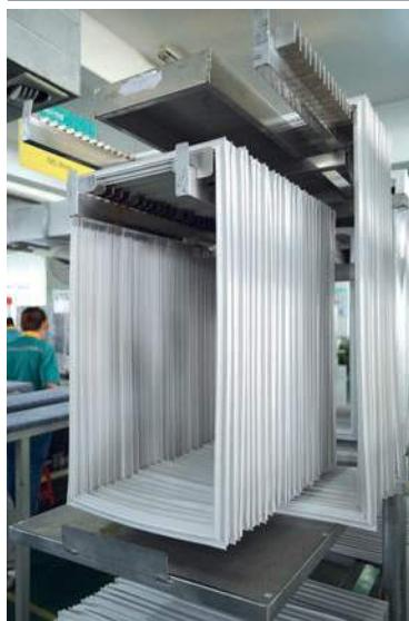
门封，往往被视为冰箱的一个普通零部件，用来实现冰箱门与箱的吸合功能。然而，在了解冰箱生产工艺的专业人士眼中，门封价值虽低，却是冰箱上非常重要的外观件和密封件，不仅关乎冰箱闭合状态下的整体美观，还承担着弥补门体和箱体的加工变形误差的功能，达到理想的密封效果，提高整机能效水平，其性能好坏直接影响食材的保鲜程度与冰箱的使用寿命。
