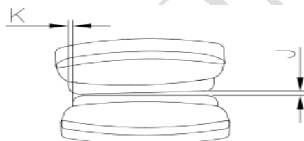
图2 上/下发热板摆嘴错位示意图
