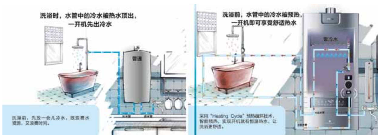
零冷水解决方案预热循环系统原理图
