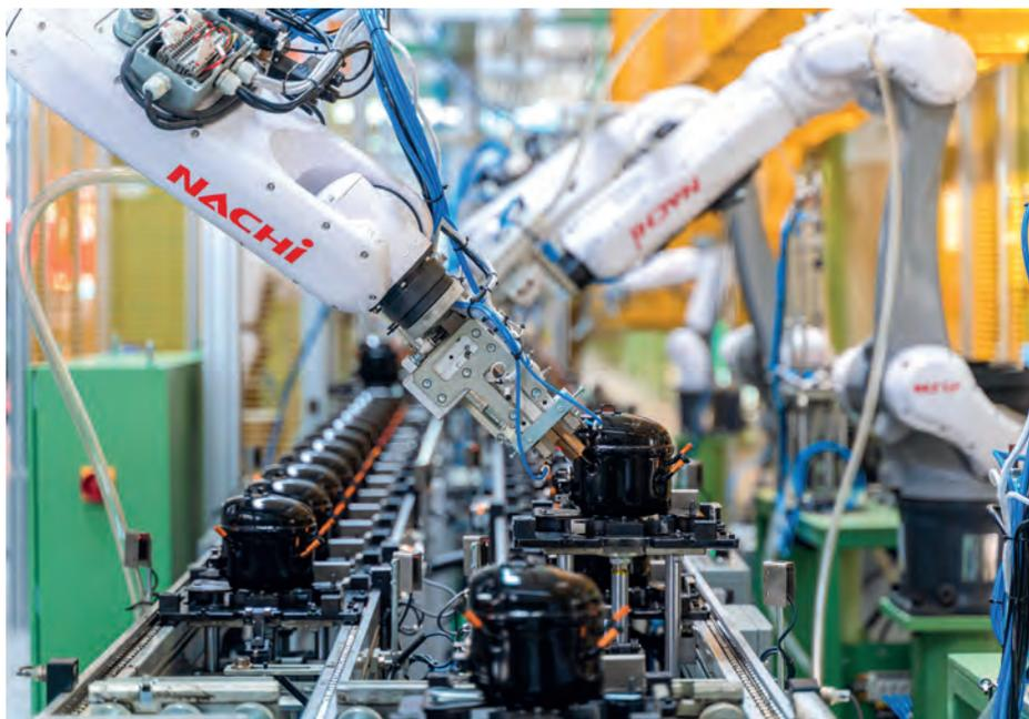
球先进的精加工设备，确保零部件加工精度，拥有3.5秒/台的高效率自动化装配线，预计可以完成全年产销3200万台冰箱压缩机的目标。
