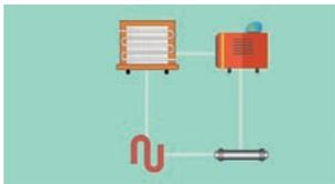
一台优质的冰箱不仅要有美观、大方的外在，更应该具备高效保鲜、节能环保、低噪静音的深厚内涵。让我们从专业角度来认识它，压缩机、冷凝器、毛细管、蒸发器，这些都是冰箱最重要的组成部件，通过制冷剂在它们之间不断地循环，就实现了冰箱内的制冷过程。
