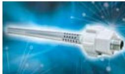
**镁棒：**镁棒在热水器中是作为牺牲阳极使用的。因为镁的金属活性比铁高，在镁棒与普通钢板同时暴露的情况下，镁棒首先代替钢板被腐蚀掉，从而达到保护内胆的目的。但是，并不是说镁棒的尺寸越大越好，只有根据内胆尺寸的不同而合理匹配的镁棒，才能有效地保护内胆。
